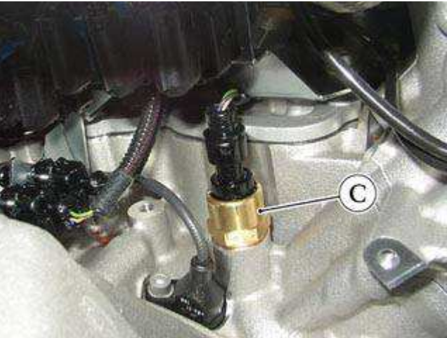
发动机机油压力通过曲轴箱右后侧的传感器 (C) 测量。
