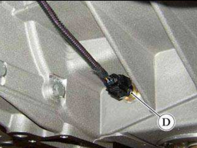
发动机机油温度通过左侧差速器盖下方变速箱壳体上的热敏电阻器 (D) 测量。
